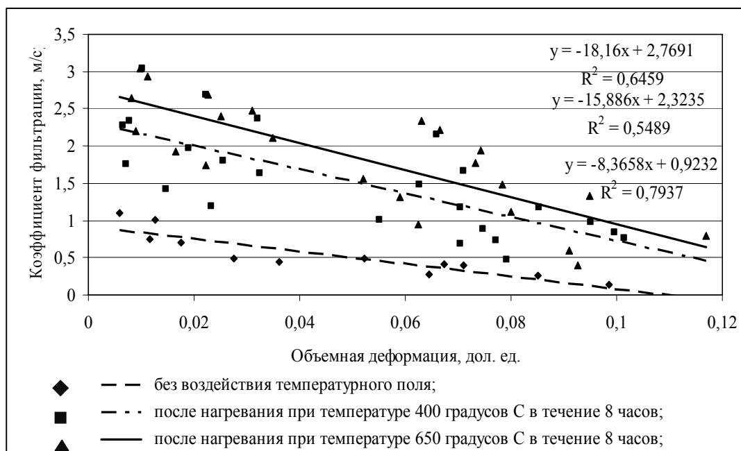
Рис. 1. Результаты фильтрационных испытаний образцов песчаных грунтов нарушенного сложения бучакско-киевской свиты палеогена в условиях трехосного напряженного состояния
