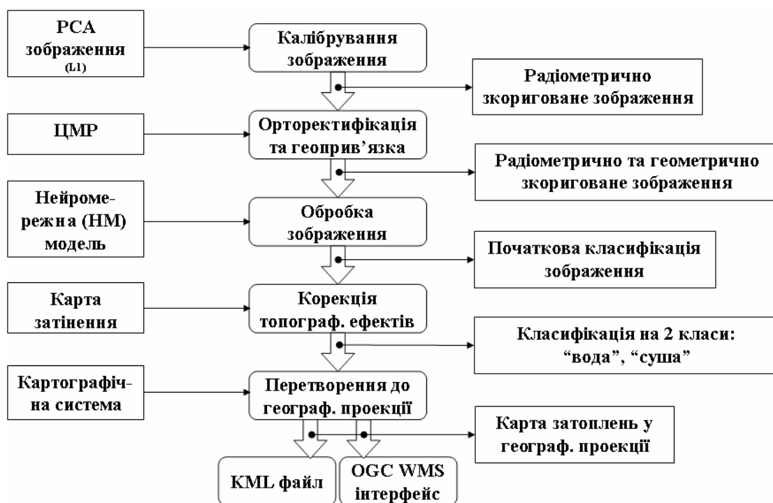
Рис. 2. Алгоритм картографування затоплень на основі радіолокаційних зображень
