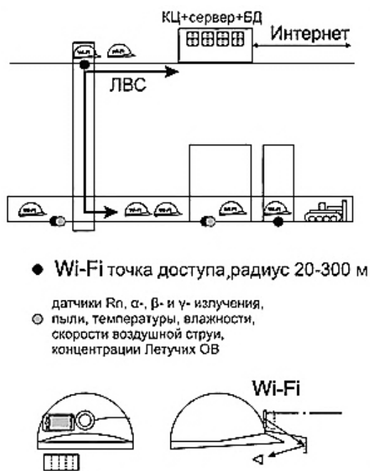
Рис. 2. Общая схема комплекса прогнозирования событий с использованием наложенной виртуальной реальности: КЦ (концентратор) + сервер + БД (база данных)+ЛВС (локальная вычислительная сеть)
