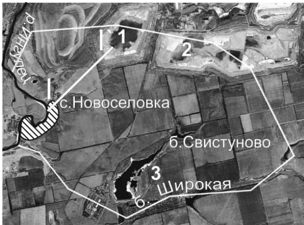
Рис. 1. Объекты техногенной нагрузки в пределах исследуемой территории (М 1:100000): 1, 2 – хвостохранилища ЮГОКа „Войково“ и „Объединенное“; 3 – пруд-накопитель шахтных вод в балке Свистуново
