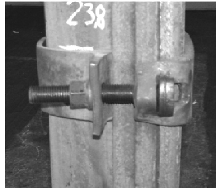
Рис. 6. Соединение трех профилей типа V с использованием замка типа SDO
