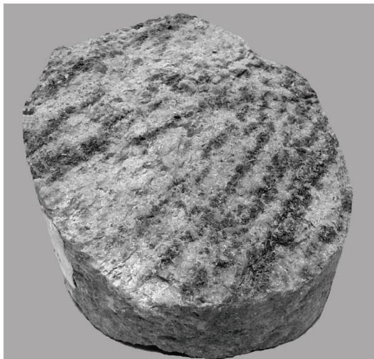
Рис. 4. Образец керна К-22 скв. № 3 Скворцовской площади, интервал залегания 3 326-3 329 м, плагиогранит
