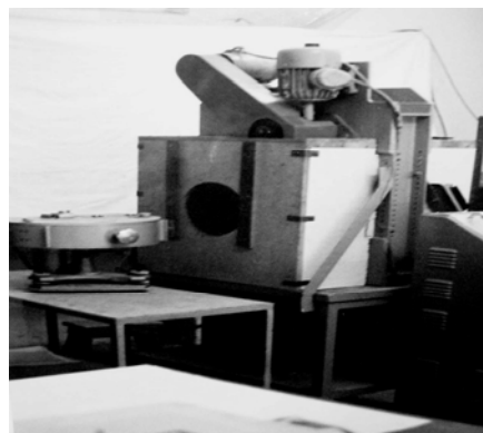
Рис. 1. Стенд для скоростной фоторегистрации быстропотекающих процессов
