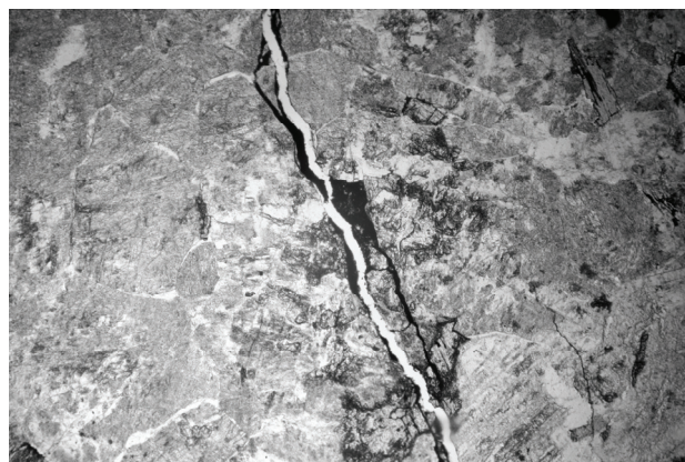
Рис. 1. Шлиф скв. № 1 Юльевской площади, интервал залегания 3537-3543 м, габбро – амфиболит
