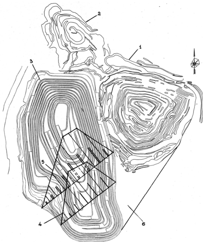
Рис. 2. Схема развития внутреннего отвала в карьере №2-бис: 1 – отработанный карьер №1; 2 – рекультивированный Бурцицкий отвал; 3 – карьер №2-бис; 4,5 – контуры внутреннего отвала с подошвой на гор. – 240 и –300 м; 6 – контуры внешнего отвала между карьерами №1 и №2-бис
