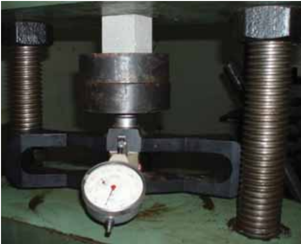
Пристрій для моделювання впливу кріплення на породи кривлі
