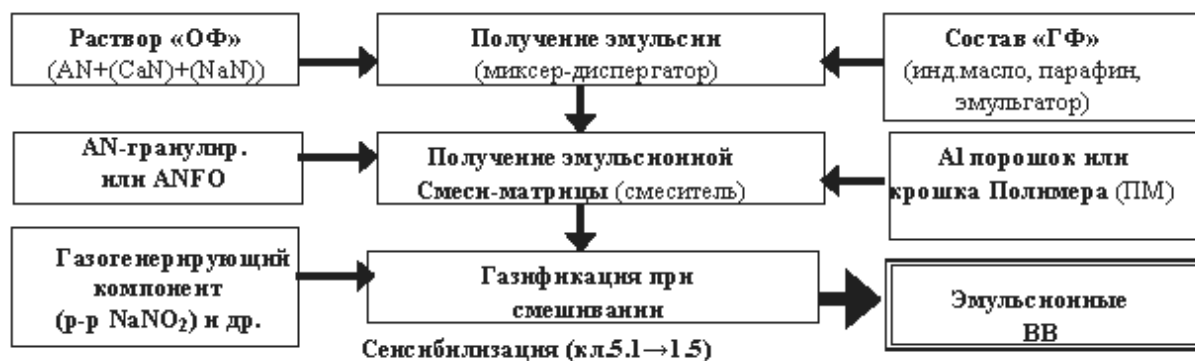
Рис. 2. Схема изготовления ЭВВ „ЕРА“
