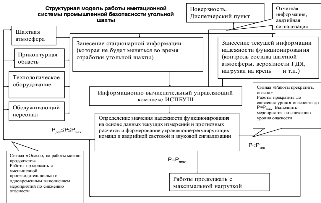
Рис. 1. Структурная модель имитационной системы промышленной безопасности угольной шахты (ИСПБУШ)
