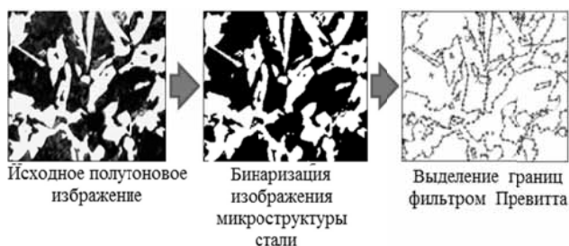
Рис. 2. Результат предварительной обработки изображения микроструктуры металла
