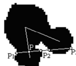
Рис. 2. Пересечение прямой контура невыпуклого объекта: P – точка линии скелета; P_1 , P_2 , P_3 – точки пересечения контура агрегата с перпендикуляром к линии скелета, проведенным в точке P
