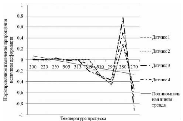
Рис. 5. Нормированное изменение приращения деформации, нормированной по максимальной температуре
