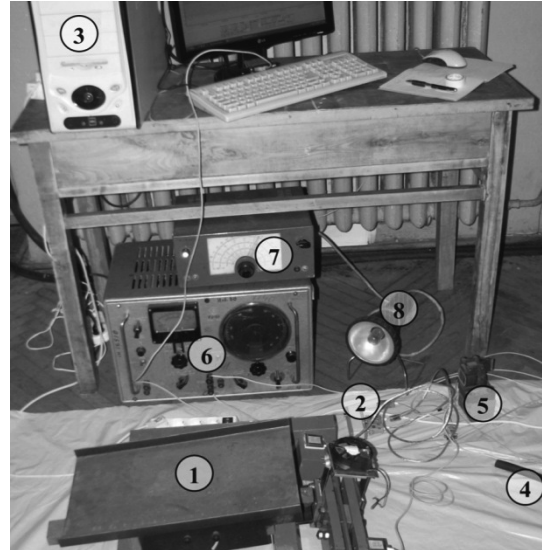
Рис. 9. Вібраційна машина з під’єднаним до неї вимірювальним лабораторним обладнанням
