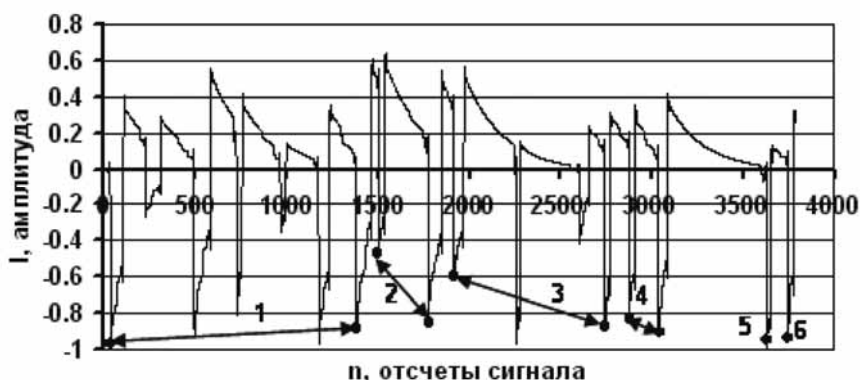
Рис. 6. Сигнал, соответствующий одновременному падению нескольких частиц магния (область измерения – вертикаль, Q_{\Gamma} = 21 \text{ м}^3/\text{ч} , u_{\Gamma} = 45 \text{ м/с} , \alpha = 30^\circ ): 1–6 – выделенные подмножества импульсов
