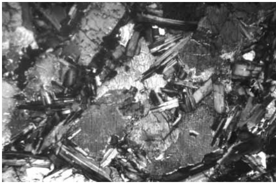
Рис. 5. Долерит (зразок 5). Широкопластинчасті кристали з тріщинами спайності – піроксен, видо- вжені призматичні кристали з двійниками – пла- гіоклаз. Світло прохідне, ніколи (+), збільш. 47 x
