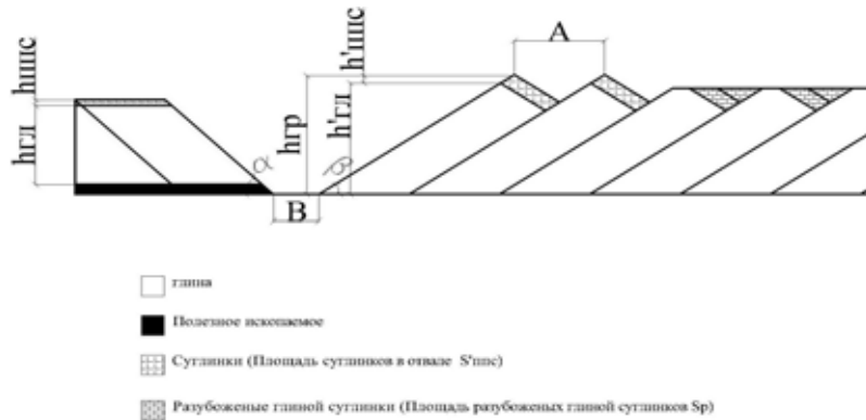
Рис. 2. Отсыпка внутренних отвалов
