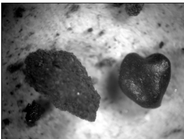
Рис. 5. Грудувате зерно і стяжіння гетиту. Осадок р. Інгулець в районі м. Кривий Ріг. Бінокуляр. Збільшення 60X
