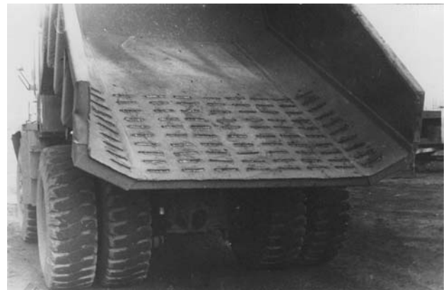
Рис. 6. Кузов автомобиля БелАЗ, армированный поперечными стержнями
