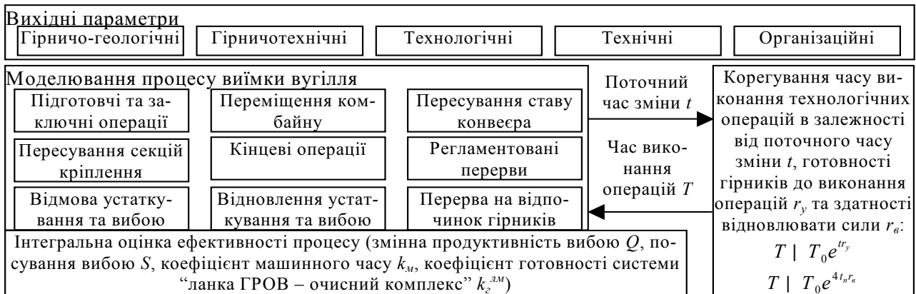
Рис. 1. Загальна схема моделювання системи „ланка ГРОВ – очисний комплекс“ у процесі виїмки вугілля
