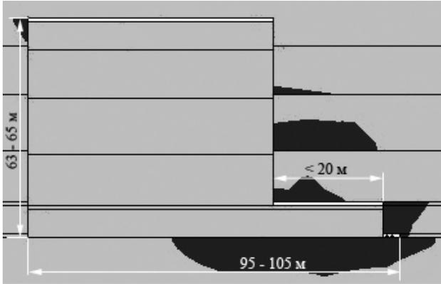
Рис. 5. Распределение зон предельного состояния горных пород при отходе лавы до 95-105 м:
