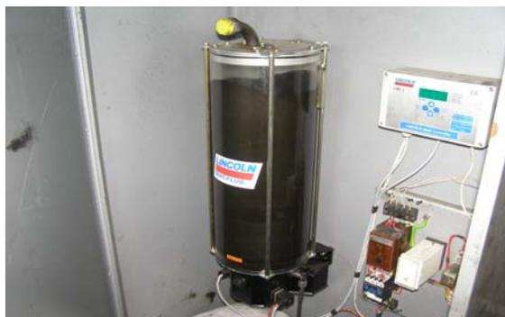
Рис. 2. Блок управління с насосом
