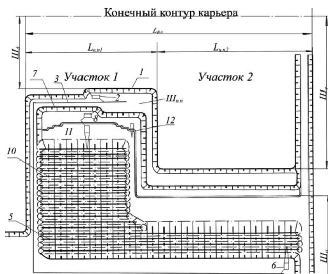
Рис. 1. Технологическая схема разделения карьерного поля на два участка
