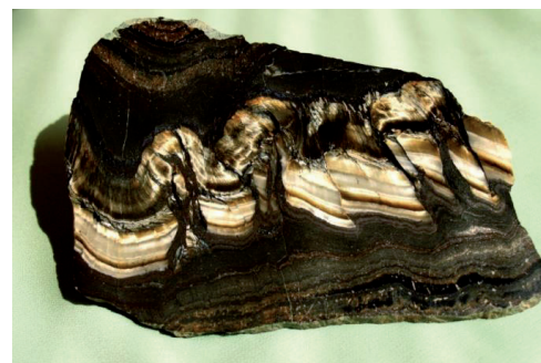
Рис. 7. Початкова стадія заміщення сірого соколиного ока тигровим оком у зв'язку із заміщенням кумінгтоніту дисперсним гетитом по окремих зонах самоцвіту. Розмір зразка за максимальним виміром 12 см
