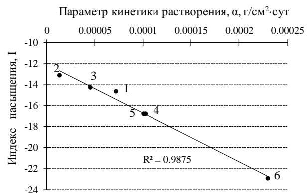
Рис. 2. Зависимость интенсивности выщелачивания ионов Ca 2+ от карбонатной агрессивности вод
