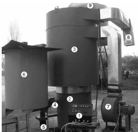
Рис. 1. Твердопаливний теплогенератор : 1 – автоматична система керування; 2 – камера згорання палива; 3 – теплообмінник; 4 – регульований двигун подачі біопалива; 5 – регульований двигун подачі паливної суміші; 6 – паливний бункер; 7 – вентилятор нагнітання теплоносія; 8 – вихідний повітропровід; 9 – димар
