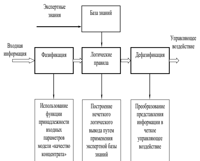
Рис. 2. Структурная схема работы нечеткого регулятора (НР)
