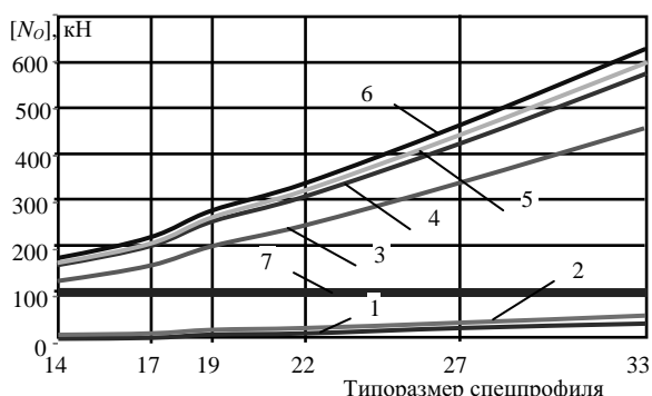
Рис.5. Требуемое сопротивление узлов податливости [N_0] при вертикальной распределённой нагрузке
