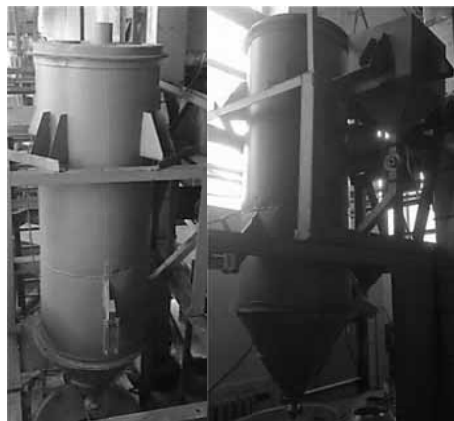
Рис. 1. Опытно-промышленный образец вихревого гранулятора взвешенного слоя
