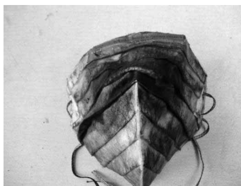
Рис. 4. Вигляд респіратора після запылення на циклічному потоці
