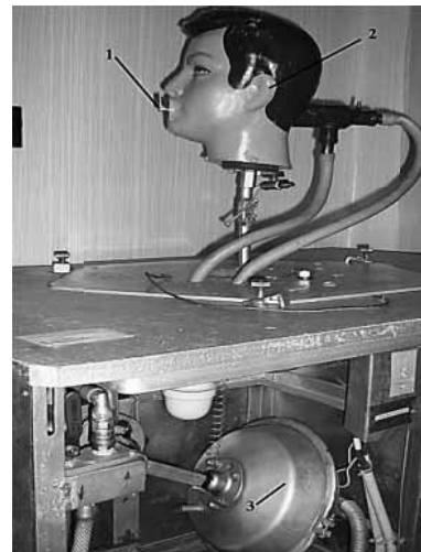
Рис. 2. Муляж голови та дихальна машина: 1 – пробовідбірник з підмаскового простору ЗІЗОД; 2 – шеффілдський муляж голови; 3 – дихальна машина
