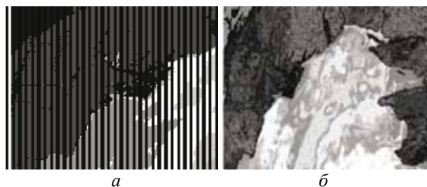
Рис. 4. Результат иерархической сегментации космоснимка для различного количества нейронов самоорганизующейся карты Кохонена : а – 10; б – 240
