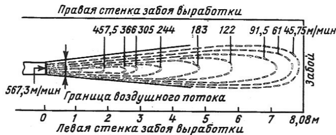
Рис. 2. Изменение скорости движения вентиляционной струи в горизонтальной плоскости по мере удаления от конца трубопровода (расположение трубопровода в центре выработки на высоте 1,22 м от почвы, между концом трубопровода и забоем 8,08 м)
