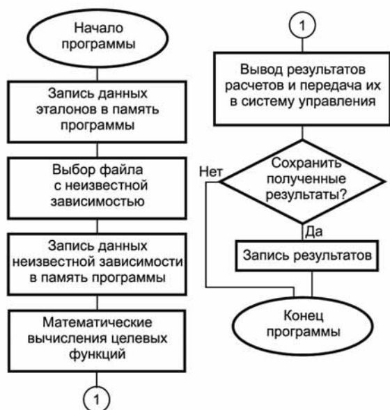
Рис. 1. Алгоритм работы программы идентификации и контроля калорийности топлива
