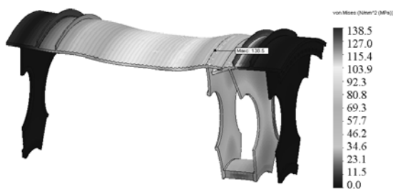
Рис. 12. НДС барабана без підкріплень зі зміцненням на дві канавки (124 мм)
