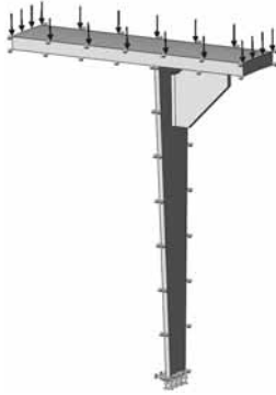
Рис. 8. Твердотільна модель 1/16 барабана
