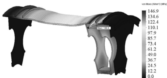
Рис. 13. НДС барабана без підкріплень зі зміцненням на три канавки (186 мм)
