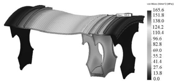
Рис. 10. НДС барабана без підкріплень без зміцнення (вихідний варіант)
