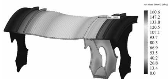
Рис. 11. НДС барабана без підкріплень зі зміцненням на одну канавку (62 мм)
