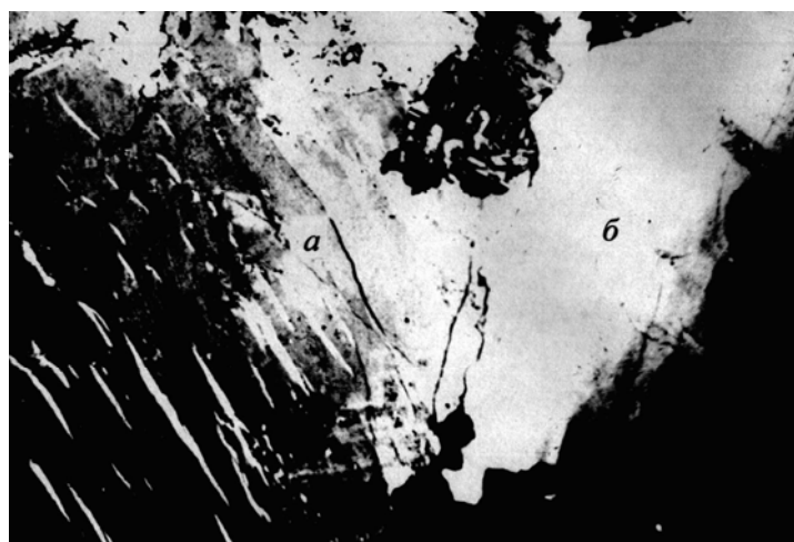
Рис. 3. Следы сдвиговых деформаций в гранитах УЩ: a – микропертит; б – кварц с волнистым угасанием (микрофотография – увеличение 40\times , поляризованный свет)
