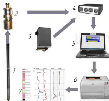
Рис. 1. Беспроводная система СРТ компании «Geotech»: 1 – зонд СРТ; 2 – микрофон; 3 – синхронизатор глубины; 4 – интерфейс ПК; 5 – ПК; 6 – принтер; 7 – результаты
