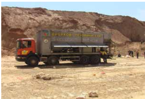
Рис. 2. Смесительно-зарядная машина UMS
