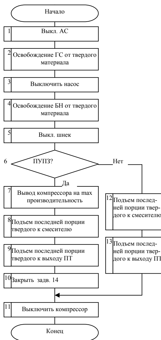
Рис. 2. Блок-схема алгоритма останова экспериментального ГЭГ
