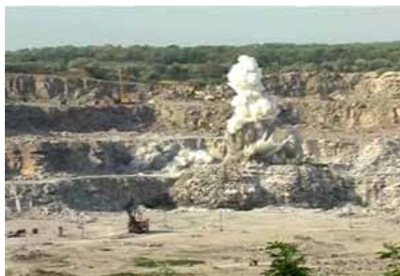
Рис. 3. Газопылевое облако, образовавшееся в результате взрыва ЭВВ марки “ЕРА”
