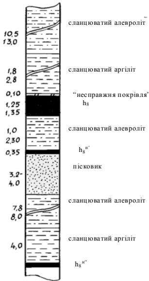
Рис. 1. Літологічна колонка 7-ї південної лави південної панелі (ПП) №1 пласта h_8 шахти «Прогрес» ДП «Торезантрацит»
