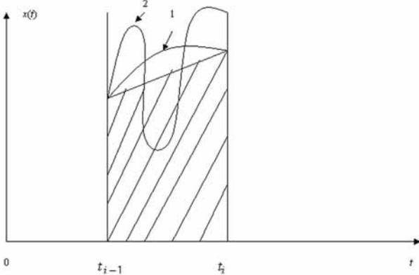
Рис. 3. Иллюстрация зависимости точности вычисления средней хронологической величины моментного ряда от интервала отсчета
