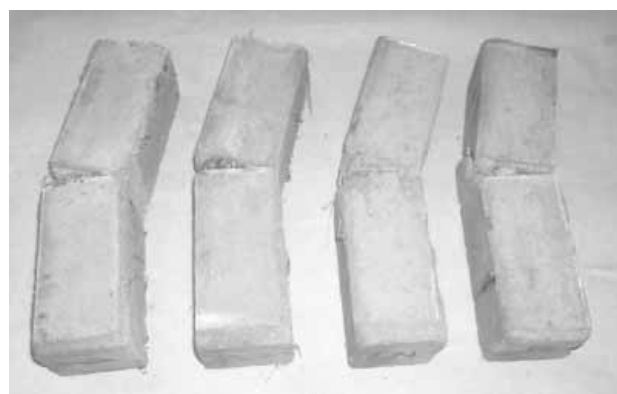
Рис. 4. Балочки после проведения испытания на растяжение при изгибе: 1, 2 – образцы с жесткой фиброй, 3, 4 – образцы с извилистой фиброй
