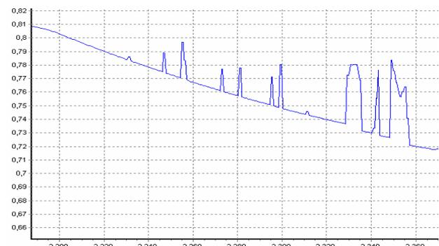
Рис. 5. Снижение кинематического КПД ГОМТ при повышении нагрузки
