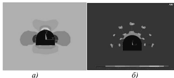
Рис. 6. Распределение напряжений вокруг выработки арочного сечения для традиционного крепления (а) и с мероприятиями по сжатию пород при помощи НРМ, с давлением саморасширения в шпуре – 15 МПа (б), рассчитанные по первой теории прочности
