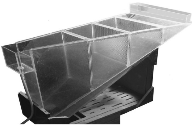
Рис. 6. Макет удосконаленого горизонтального відстійника (масштаб 1:20)
