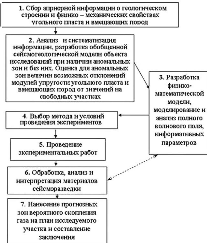
*Рис. 1. Обобщенная схема проведения сейсморазведочных работ по прогнозу зон вероятного скопления метана*
