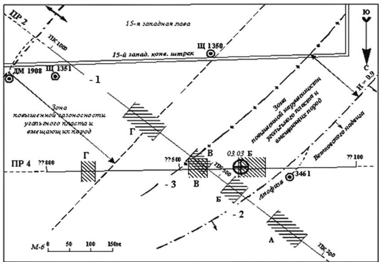
Рис. 3. Результаты сейсмических исследований на уровне угольного пласта  $m_3$  их. „Им. А.Ф. Засядько“ (фрагмент западной части участка исследований):
