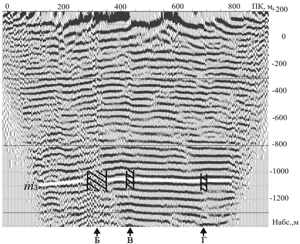
Рис. 2. Глубинный сейсмический разрез по профилю 4 на участке „Кальмиусский Рудник“ поля шахты „Им. А.Ф. Засядько“: Б, В, Г – аномальные зоны
