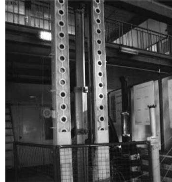
Рис. 6. Испытание трехэлементных стоек усиления
