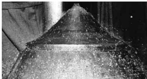
Рис. 1. Разделение минеральных частиц в гидроклассификаторе
