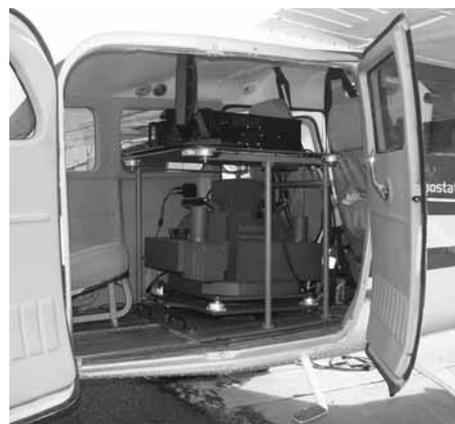
Рис. 2. Камера 3-DAS-1, установленная в самолете Cessna 206
