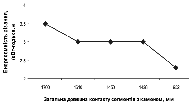
Рис. 2. Залежність енергоємності різання від загальної довжини контакту сегментів з каменем
