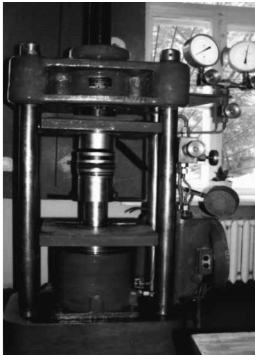
Рис. 7. Лабораторная установка НПО-1 в процессе создания термобарических условий с целью получения газовых гидратов
